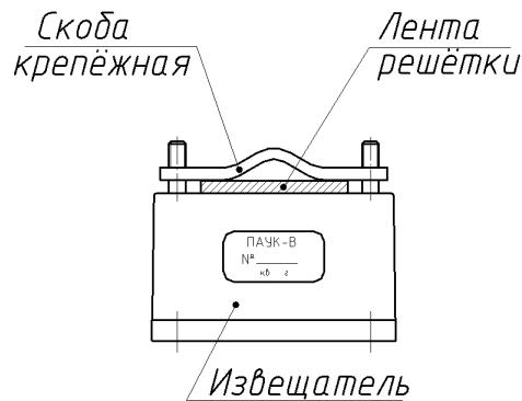
Рисунок 3.2 – Крепление извещателя на решётке из металлических лент
