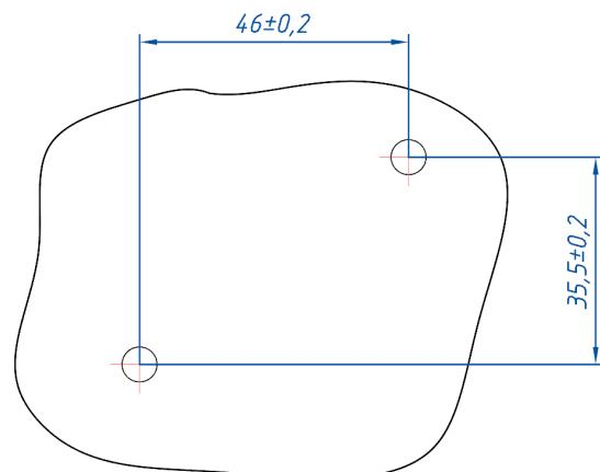
Рисунок 3.3 – Разметка для сверления отверстий
