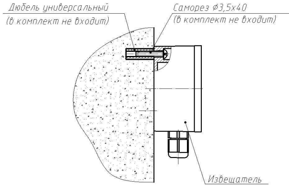
Рисунок 3.5 – Крепление извещателя на ж/б или кирпичном заграждении
