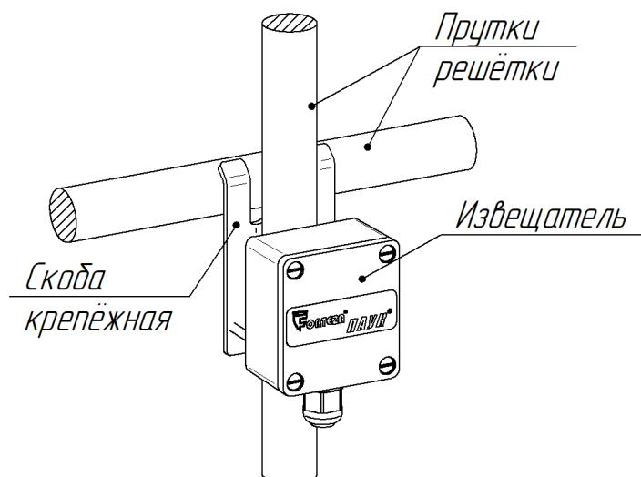
Рисунок 3.1 – Крепление извещателя на решётке из прутка
